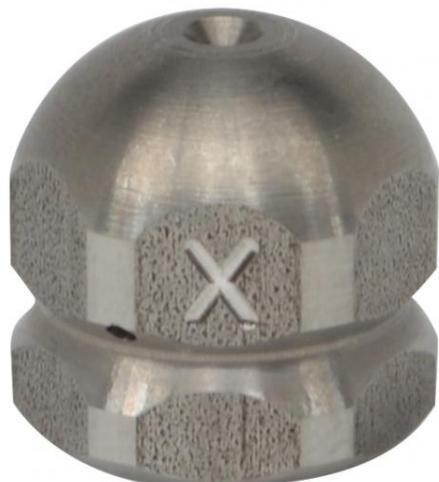
Ce gicleur HP en acier inoxydable est conçu pour le débouchage efficace des canalisations d'un diamètre compris entre 50 et 200 mm. Son jet frontal puissant cible directement les obstructions, tandis que ses trois jets propulseurs favorisent l'avancement du flexible sur lequel il est monté.
